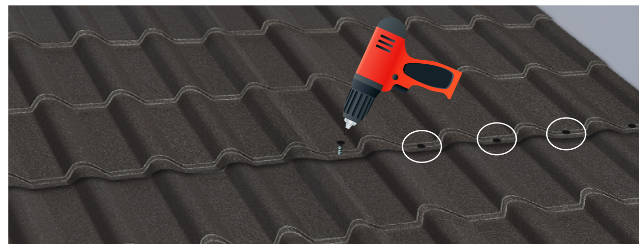
Figura 16. Fixarea colilor de tablă îmbinate.
