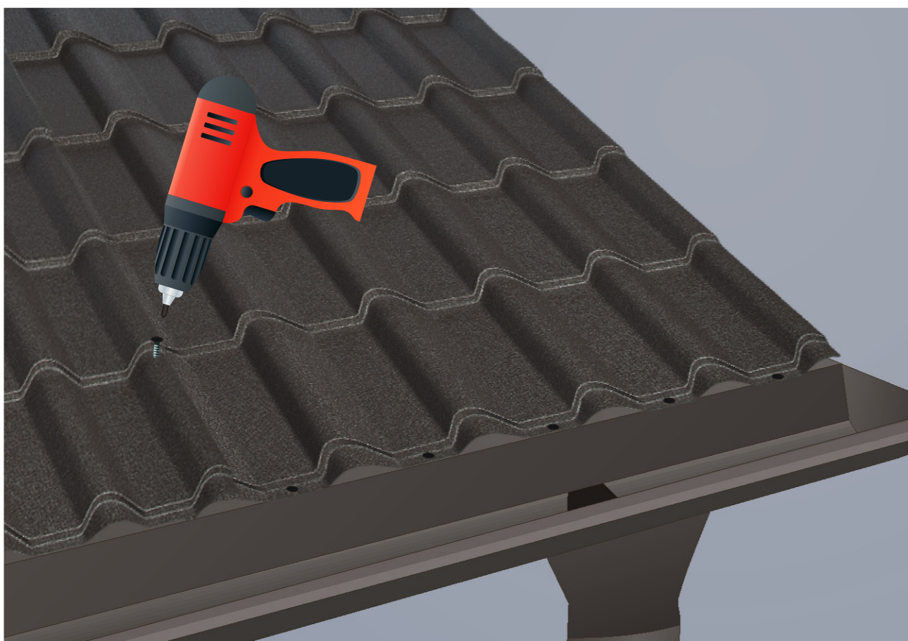
Figura 13. Fixarea colilor cu șuruburi autoforante cu garnitură 4,8x20 sau 4,8x35.
