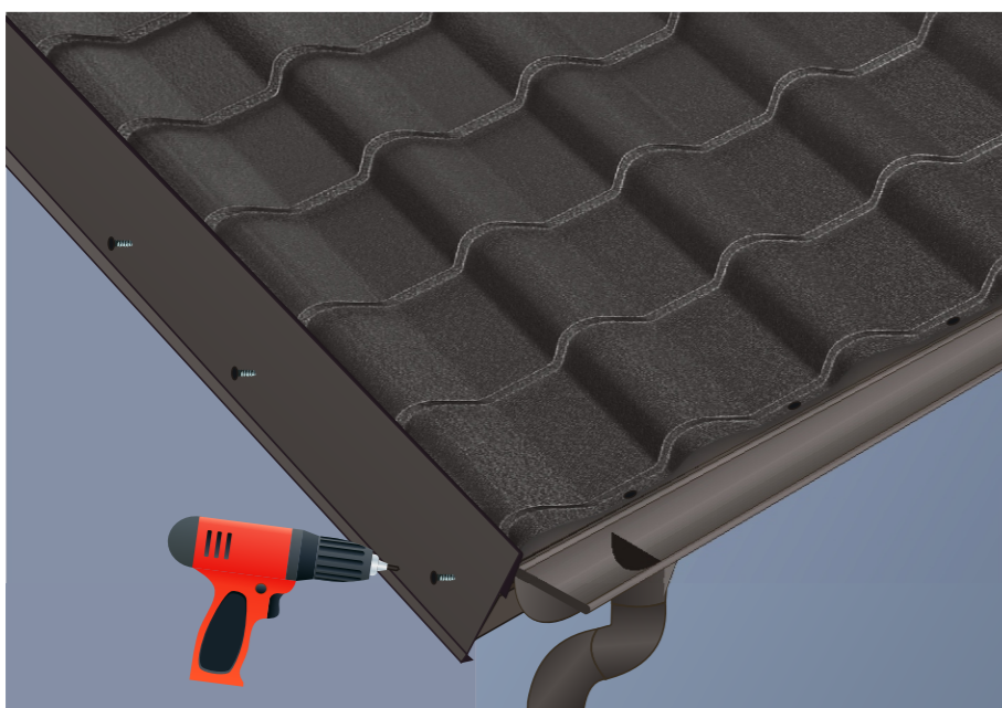
Figura 25. Montajul bordurii fronton sub acoperiș.
